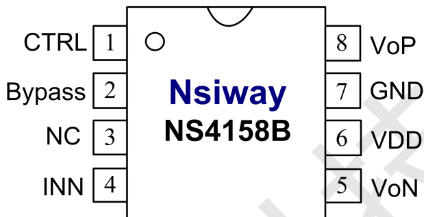
NS4158B 封装管脚分配图(top view)
