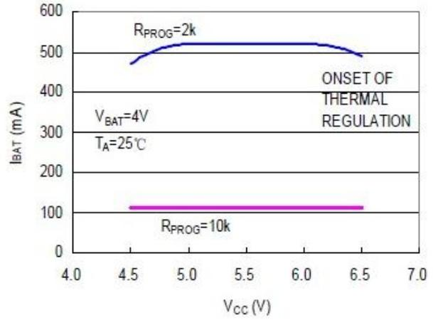
涓流充电电流 VS 电源电压
