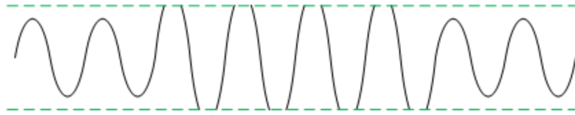
图 5-2. NCN_OFF 模式下的音频输出信号
