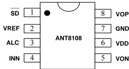
图2. ANT8108 引脚分配图(top view)
